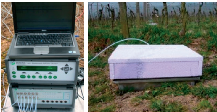
Abb. 2: Photoakustischer Gasanalysator mit Messtellenumshalter (links) und geschlossener Kammer im Feld (rechts).
